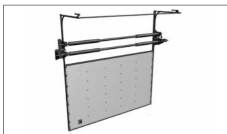
Высокий подъем, с выносным рычагом, двухроликовая система.
